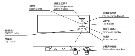
如出水溫度始終達不到設置溫度,則可適當調節"水量調節旋鈕",以使出水溫度達到設定溫度,順時針調節水量減少,溫度上升,逆時針調節水量增大,溫度下降
